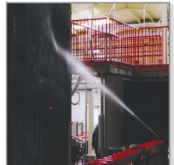
図2：プロトタイプを用いた 圧力テスト (100psi)
