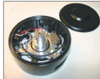
FORTUS DDM(実パーツ造形製造)による筐体に、各種部品が収まっている様子
