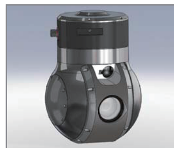
ジンバル(回転式)モニタ「COLIBRI」の3DCAD設計図
