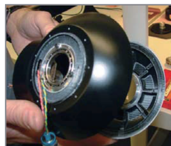
FORTUS DDM(実パーツ造形製造)により筐体を含む20台以上の「COLIBRI」をリリース
