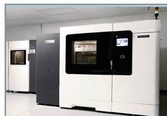
Rapid PSI社のFORTUS造形機は世界中のジェット機メーカーのための量産部品を製造している。
