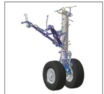
主脚の設計検証と試験のためのデジタルと現物のモックアップ。Messier-Dowty社は設計、解析、と現物モックアップのためのFDM造形用にCATIAを活用。
