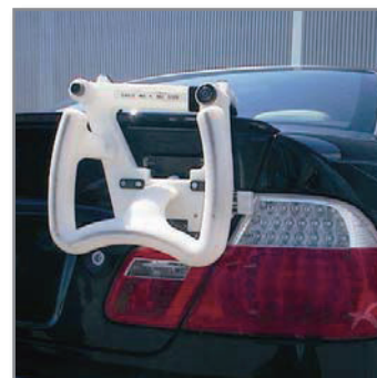
FDM造形した治具を用いた BMW M3リアエンブレムの取付
