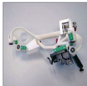
FDM造形した自動車バンパーサポート装着時の固定磁石装着用治具
