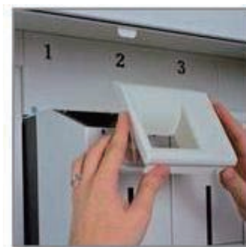
受具はFORTUSのDDM(実パーツ造形製造)により供給される (白い部品がFORTUSによる造形品)
