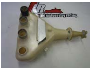
図3：テスト走行後に破損したABS樹脂モデル
