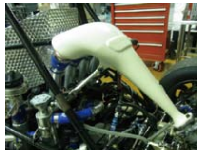
図6：フィールドテスト後に改良して制作されたABS樹脂モデル
